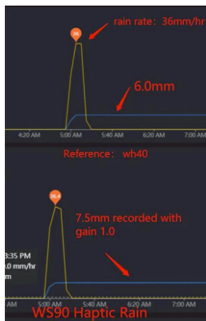
Figura 41: Exemplo de Calibração WS90 Haptic Rain
