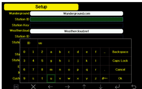
Figura 44 – Tela de Configuração do Servidor Meteorológico
