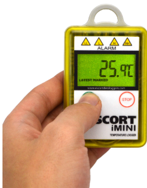
Tela LCD do aparelho Escort iMini: Função “Bookmark” indicando que a medição gravada atual foi marcada.
