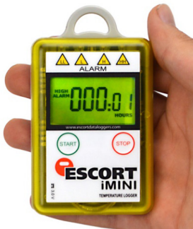
Tela LCD do aparelho Escort iMini: Terceira função do aparelho, indicando última data de acionamento do alarme alto.
