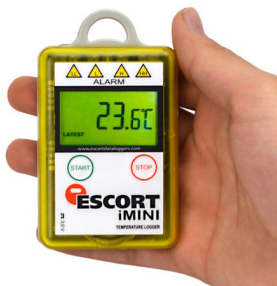
Tela LCD do aparelho Escort iMini: Função Inicial do display de último valor gravado e status de alarme.
