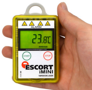
Tela LCD do aparelho Escort iMini: Segunda função do aparelho, indicando valor de temperatura média armazenada.
