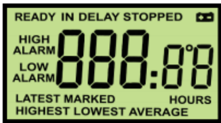
Display LCD do Escort iMini com todas as funções de ícone.
