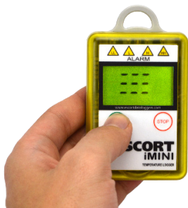
Tela LCD do aparelho Escort iMini: Inicializando medição
